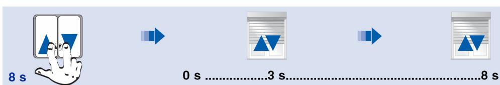
Skasowanie ustawień potwierdzane jest dwukrotnym krótkim ruchem góra/dół po 3 i po 8 sekundach
